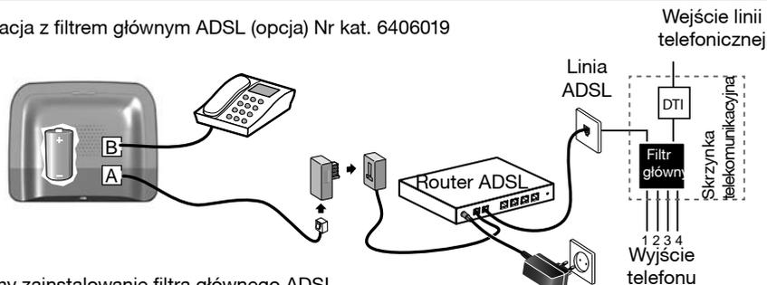
Zalecamy zainstalowanie filtra głównego ADSL.
