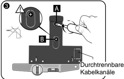
Befestigen Sie die Wandhalterung mit den 2 Schrauben (max.  $\varnothing$  4 mm) und den Bohrungen A und B.
