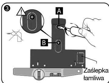
Przymocować wspornik za pomocą 2 wkrętów o maks.  $\varnothing$  4 mm, wykorzystując otwory A i B. Do wkręcania wkręta (oznaczonego jako B) nie używać wkrętarki.
