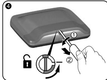
Entriegeln Sie das Gehäuse.
