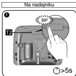
Nacisnąć na przycisk T2 nadajnika i przytrzymać przez 5 sekund. Nadajnik emituje sygnał bip.
