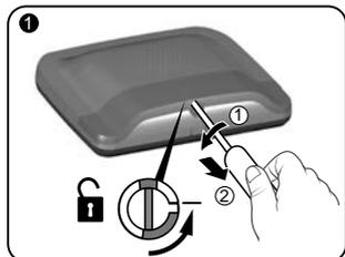
Entriegeln Sie das Gehäuse.
