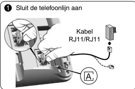
Sluit de RJ11/RJ11 kabel aan op de telefoonlijn door de RJ11-adaptor in te voegen, de geschikt is voor uw installatie.
