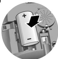
Inserite la pila rispettando la polarità.
