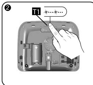
Drücken Sie kurz die Taste T1 des Empfängers. Die Kontrollleuchte leuchtet kurz grün auf.
