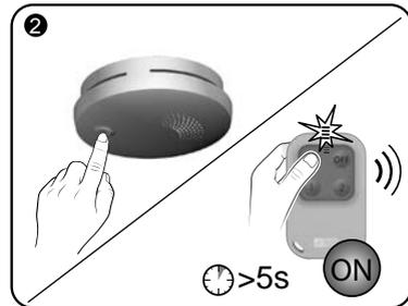
Drücken Sie die Taste des Melders. (z. B.: Rauchmelder). Drücken Sie 5 Sekunden lang die Taste ON der Fernbedienung.
