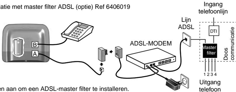
We raden aan om een ADSL-master filter te installeren. Geplaatst voor de lijn na DTI, dit apparaat vermindert de elektromagnetische interferentie door het ADSL-sigitaal van de telefoonlijn te scheiden. Het verbetert het naast elkaar bestaan van verschillende apparaten die met uw telefonische installatie zijn verbonden.
