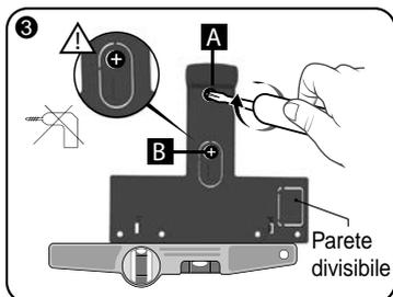
Fissate il supporto usando 2 viti  $\varnothing$  4 mm max. utilizzando i fori A e B. **Non utilizzate un avvitatore per avvitare la vite contrassegnata B.**
