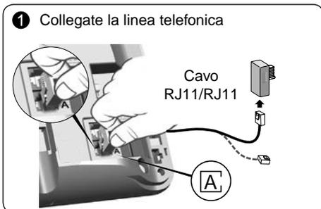
Collegate il cavo RJ11/RJ11 alla linea telefonica inserendo l'adattatore RJ11 adatto al vostro impianto.
