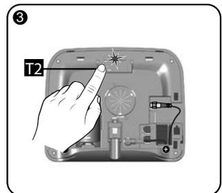
Drücken Sie die Taste T2 des Empfängers. Die Kontrollleuchte leuchtet rot-grün auf.
