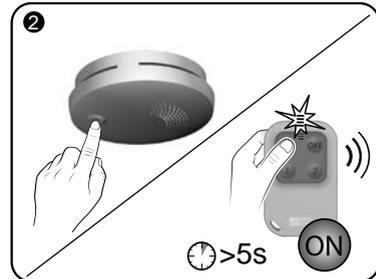
Pulse la tecla del detector. (ejemplo: detector de humo) Pulse durante 5 segundos la tecla ON del telemando
