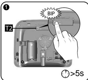
Pulse la tecla T2 del transmisor durante 5 segundos. El transmisor emite un bip.
