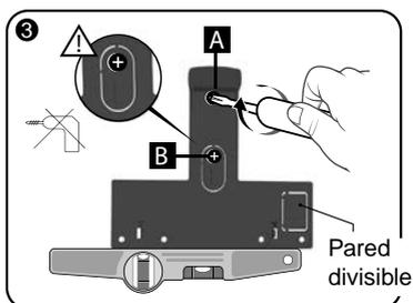
Fije el soporte mural con 2 tornillos de 4 mm Ø máx. a través de los agujeros A y B. **No utilice un atornillador eléctrico para fijar el tornillo indicado B.**
