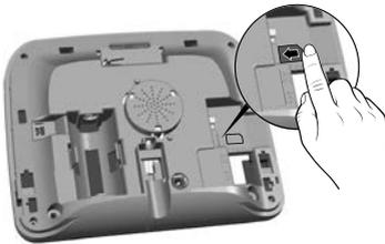
**2** Befestigen Sie das Antennenkabel.
