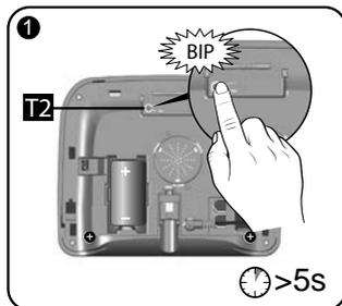
Drücken Sie die Taste T2 des Empfängers 5 Sekunden lang. Der Melder piept einmal.
