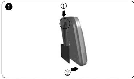
Befestigen Sie das Telefonmodem an seiner Wandhalterung.
