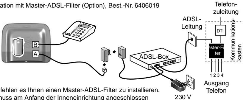
Wir empfehlen es Ihnen einen Master-ADSL-Filter zu installieren. Dieser muss am Anfang der Inneneinrichtung angeschlossen werden und minimiert die elektromagnetischen Störungen, indem das ADSL-Signal von der Telefonleitung getrennt wird. Er verbessert den gemeinsamen Betrieb, der mit Ihrem Telefonsystem verbundenen Geräte.
