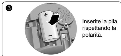
Inserite la pila rispettando la polarità.
