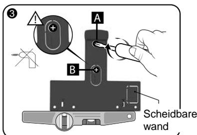
Bevestig de muurbeugel met 2 schroeven van  $\varnothing$  4 mm max. door de openingen A en B.
