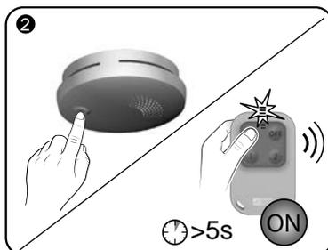
Nacisnąć przycisk czujnika. (przykład: czujnik dymu)
