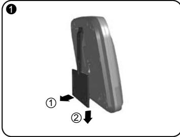
Entfernen Sie das Telefonmodem von seiner Wandhalterung.
