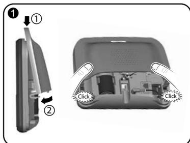
Plaats de bovenklep terug en klik deze over de behuizing.
