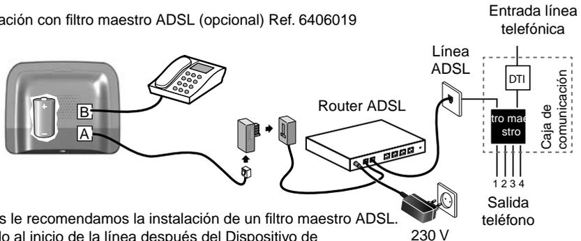
Nosotros le recomendamos la instalación de un filtro maestro ADSL. Colocado al inicio de la línea después del Dispositivo de Terminación Interior, este dispositivo reduce en gran medida las interferencias electromagnéticas separando la señal ADSL de la línea telefónica. Mejora la "convivencia" de los distintos dispositivos conectados en su instalación telefónica.
