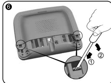
Heben Sie mit einem Schraubenzieher die 2 Clips an, die die obere Abdeckung befestigen.
