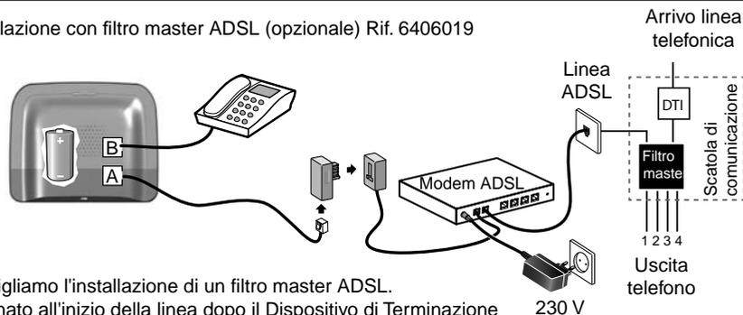
Vi consigliamo l'installazione di un filtro master ADSL. Posizionato all'inizio della linea dopo il Dispositivo di Terminazione Interno, questo dispositivo attenua fortemente le perturbazioni elettromagnetiche separando il segnale ADSL dalla linea telefonica. Migliora la coabitazione dei vari dispositivi collegati sul vostro impianto telefonico.
