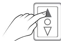
Maintenez appuyée la touche "montée", jusqu'à ce que le volet bloque contre la butée haute.
