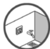
In Feuchträumen sollte der Sensor an einer ebenen Fläche gemäß den lokalen Bauvorschriften angebracht werden.
