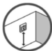
Installationshöhe, üblicherweise zwischen 80-150 cm, wenn Devireg™ 535 als Raumthermostat verwendet wird.
