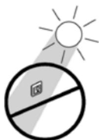
Nicht an einer Wand, wo der Sensor direkter Sonneneinstrahlung ausgesetzt wird.
