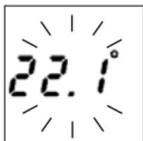
Benutzen Sie die Pfeiltasten ▲▼, um die Temperatur entweder zu erhöhen oder zu verringern. Die Temperatur wird in Schritten von 0,1°C verändert.
